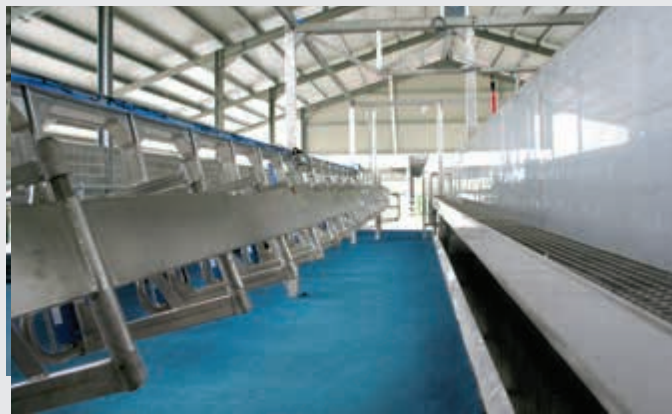
Cancelletti posizionatori mobili montati sul frontale Sequence gate inserted into the breast rail
