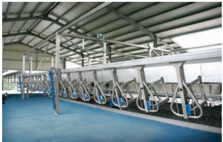
Arretramento oleodinamico del frontale Breast rail hydraulic indexing
