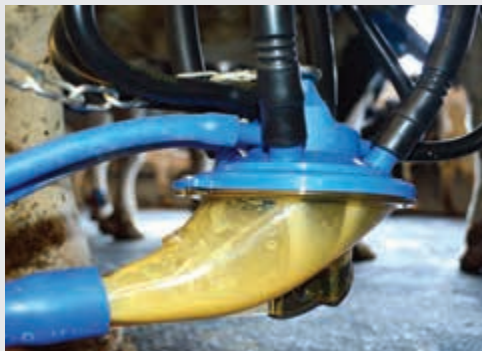
Gruppo di mungitura ConanS per flussi di latte elevati (Brevetto TDM) High flow ConanS Cluster (TDM patent)
