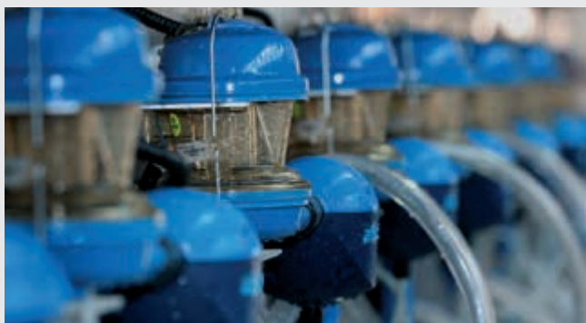
Lattometri elettronici con Afilab Electronic milkmeters with Afilab
